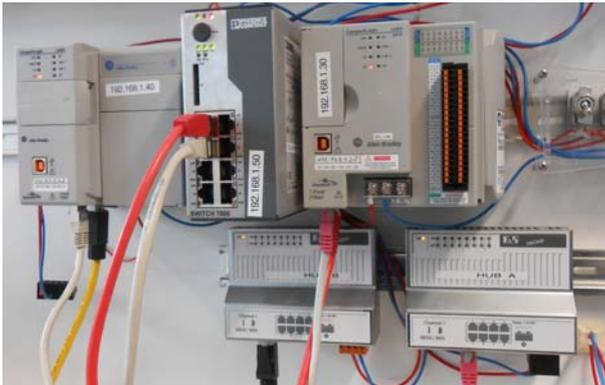
Seit 2017 können auch Geräte Scanner/Master EtherNet/IP™-Geräte sowie Geräte mit CIP Sync™ Funktionalität bei uns getestet werden (siehe Bild).
